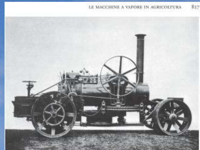
Fig. 4 Locomotiva a vapore con puleggia per la trazione funicolare dell'aratro
