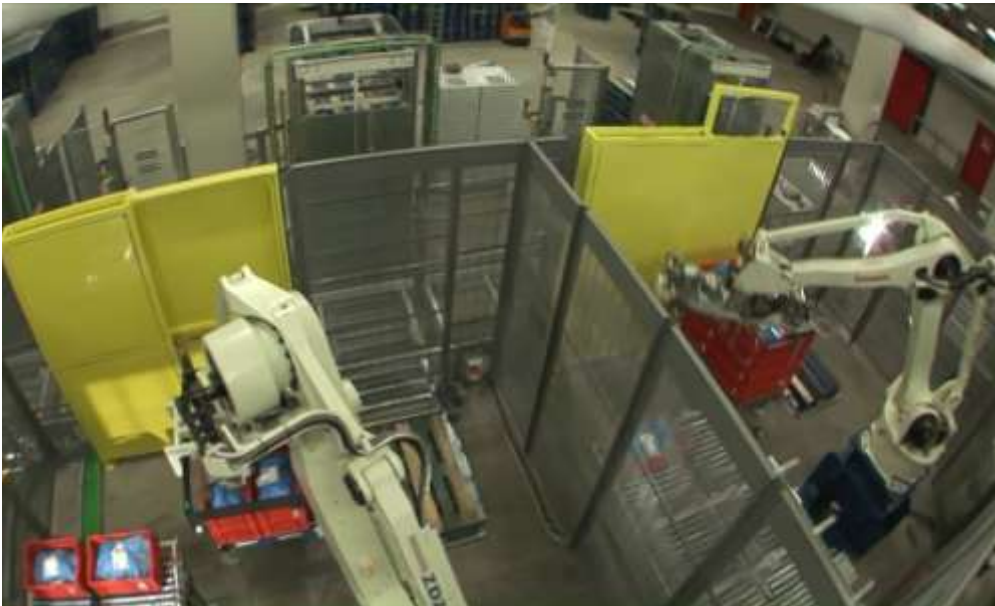
Figura 12. Movimentazione eurocontenitori con ausilio di robot.
