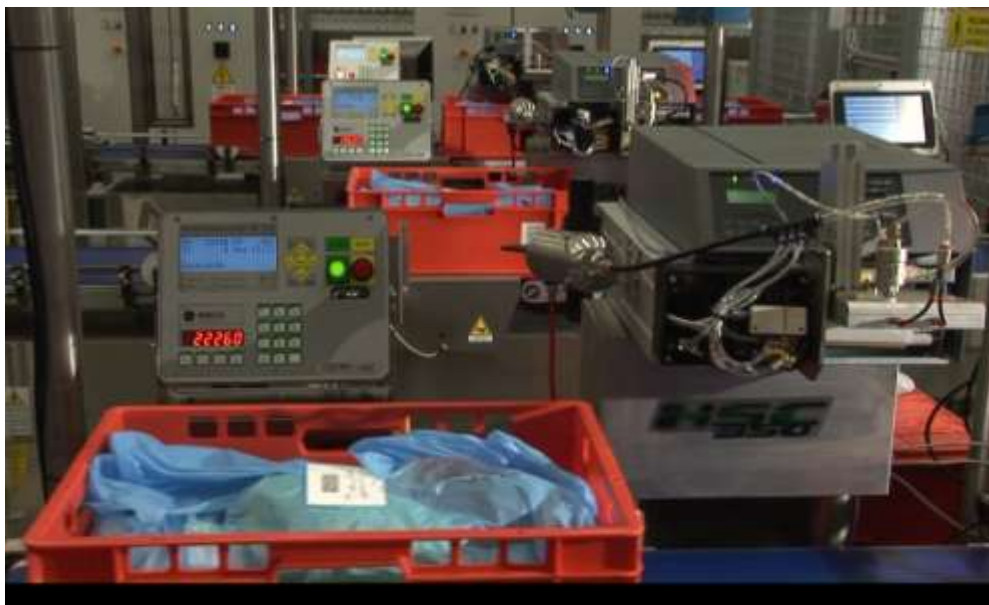
Figura 10. Assegnazione etichetta bidimensionale di tracciabilità
