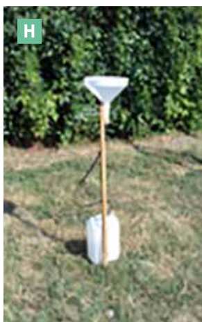
Il pluviometro collocato in campo.
