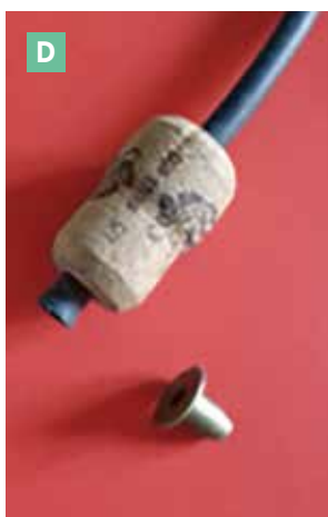
Connettore del tubo alla tanica e terminazione di fermo
