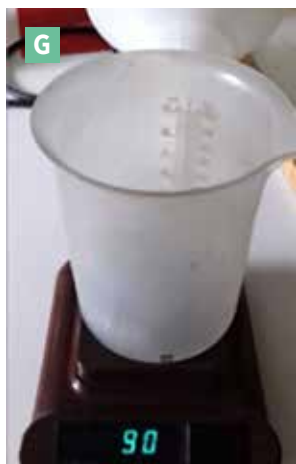
Apposizione delle graduazioni sul misurino.
