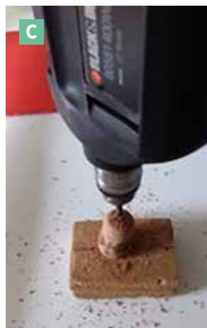
Foratura del tappo con il trapano
